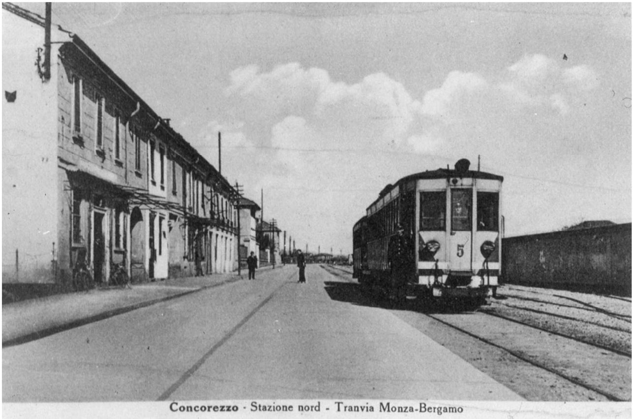
Esse non producevano fumo ed erano silenziose. Inoltre la velocità del convoglio passò dai 20 Km. all'ora del vecchio tram ai 40 Km. all'ora. Però queste nuove elettromotrici non erano forti come le vecchie motrici a vapore e potevano rimorchiare al massimo 3 carrozze. A questo nuovo tram fu dato un colore paglierino.
